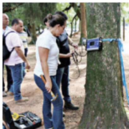
Por meio da propagação de ondas sonoras no tronco, é possível detectar áreas em diferentes estágios de deterioração, a Eng. Marina Moura de Souza utiliza um tomógrafo sônico
