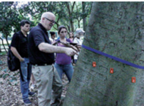
Eng. Duntemann utiliza um resistógrafo para avaliar a resistência da madeira à perfuração da broca e detectar áreas com cavidades ou decaimento
