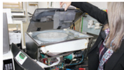
Lavadora de endoscópios, utilizada para lavagem automatizada de endoscópios, equipamentos invasivos que visualizam órgãos do corpo humano
